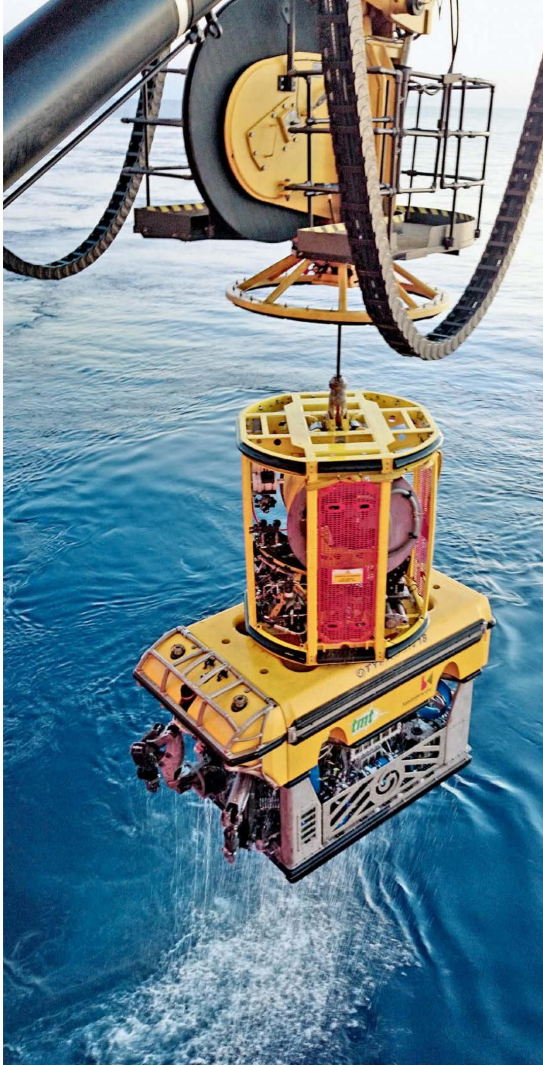
向 ROV 传送的动力——液压和电能，可供机载系统用于实现推进力或驱动液压机械臂和抓斗，助力 ROV 执行水下任务。就 TMT Typhoon MK2 ROV 而言，液压动力由 ROV 上的液压动力装置 (HPU) 产生。水上设施提供的 440 V 交流电逐步提高至 3250 V 交流电 (60 Hz)，并输送至 ROV，启动这一装置。HPU 使用 3000 V 交流系统为海底液压泵供电。
