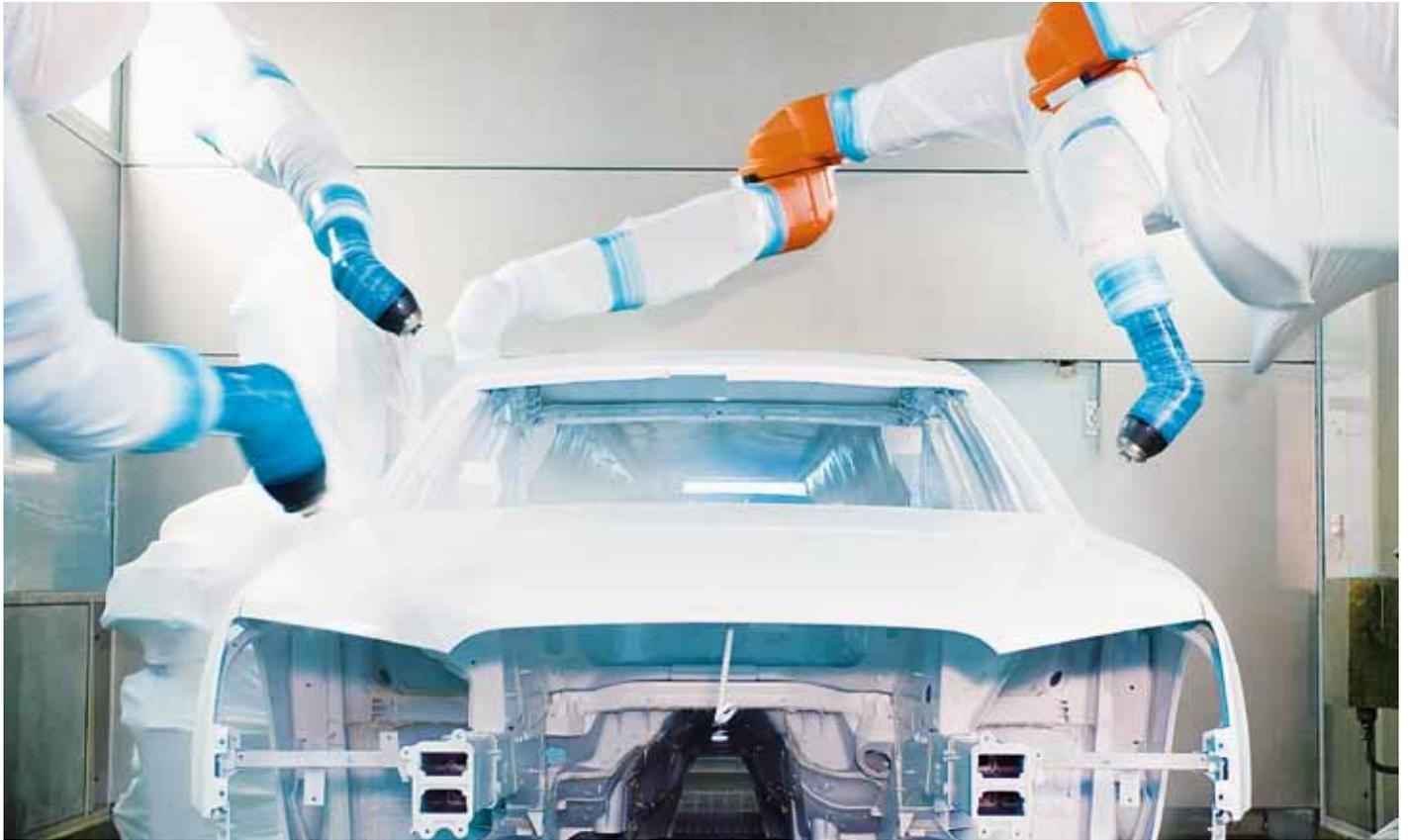
Die neuen Lackierroboter sind flexibler als die alten Portalanlagen und sorgen für einen gleichmäßigen Lackauftrag.
