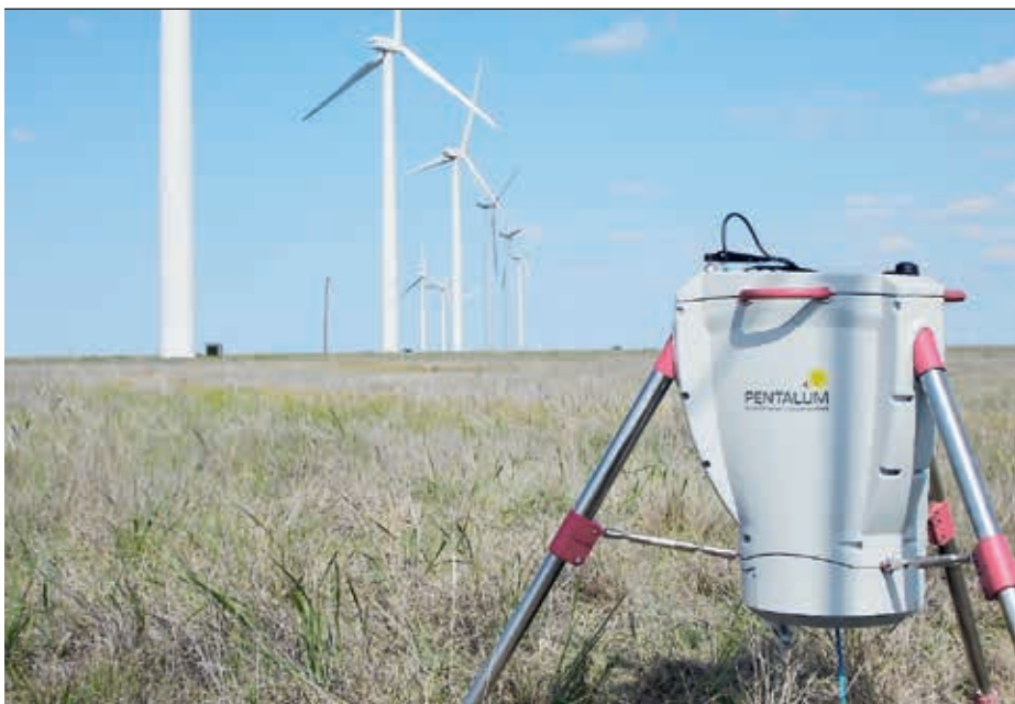
2 Dispositif SpiDAR® de mesure et de prévision de la puissance éolienne d'un site
