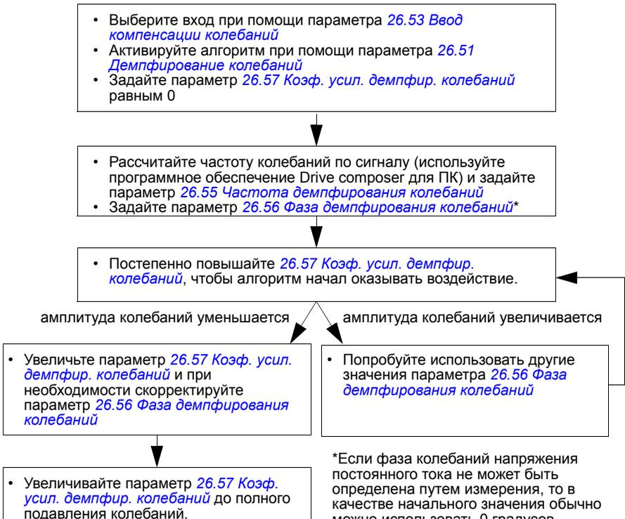
**Примечание:** На настройку алгоритма демпфирования колебаний могут влиять постоянная времени фильтра нижних частот ошибки скорости или время интегрирования регулятора скорости. Рекомендуется перед настройкой алгоритма демпфирования колебаний выполнить настройку регулятора скорости. (Коэффициент усиления регулятора скорости можно подстраивать после настройки данного алгоритма).
