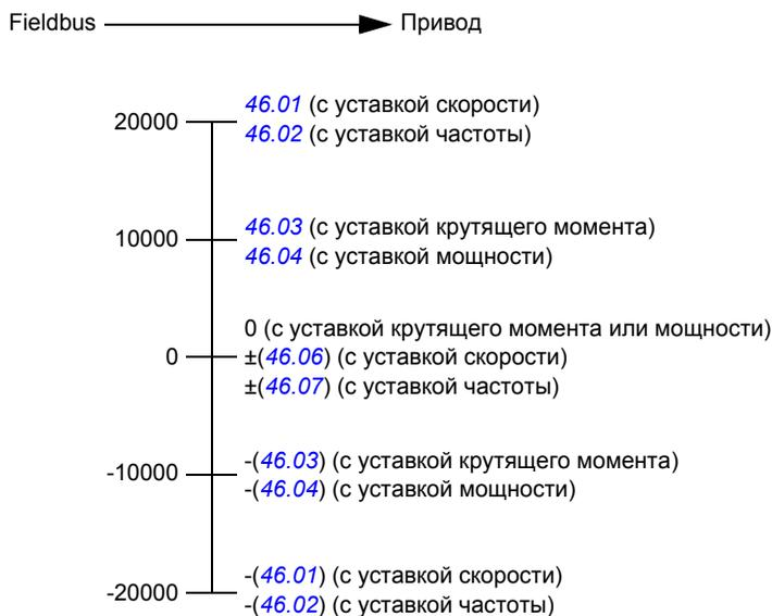
Масштабированные уставки отображаются параметрами [03.09 Уставка 1 с EFB](#) и [03.10 Уставка 2 с EFB](#).
