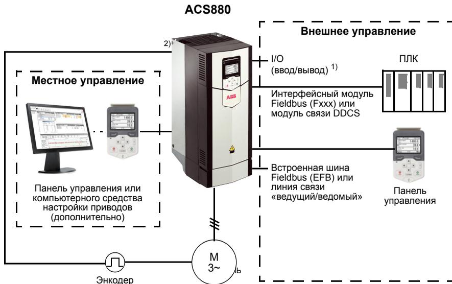
1) Дополнительные входы/выходы могут быть добавлены путем установки модулей расширения входов/выходов (FIO-xx), заказываемых отдельно, в гнездо привода.
