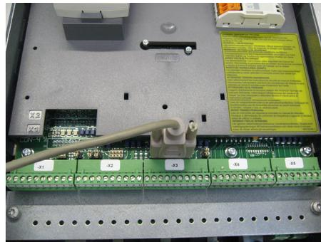
卸下 DCS550 的控制盘（如果有），下压锁移出封盖 通过 X34 连接 DCS550 到 PC 的 COM 口
