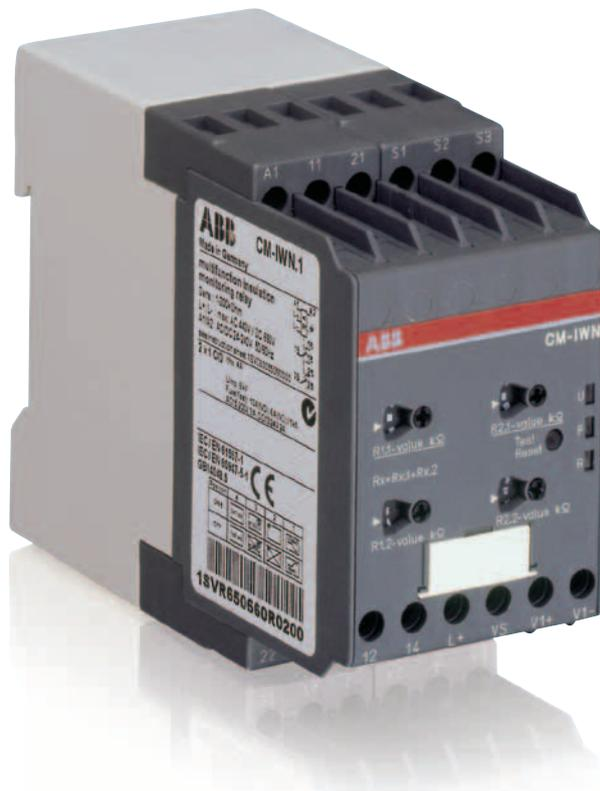
Le signal de mesure émis par les dispositifs CM-IWS.1 et CM-IWN.1 change de forme en fonction de la résistance d'isolement et de la capacité de fuite du système. Cette altération permet de déduire la modification de la résistance d'isolement.
