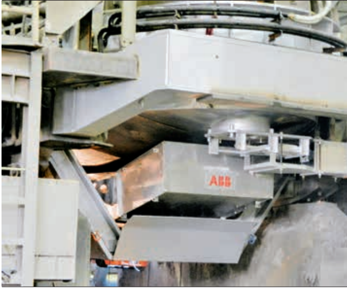
1a Brasseur ABB monté sous le four
