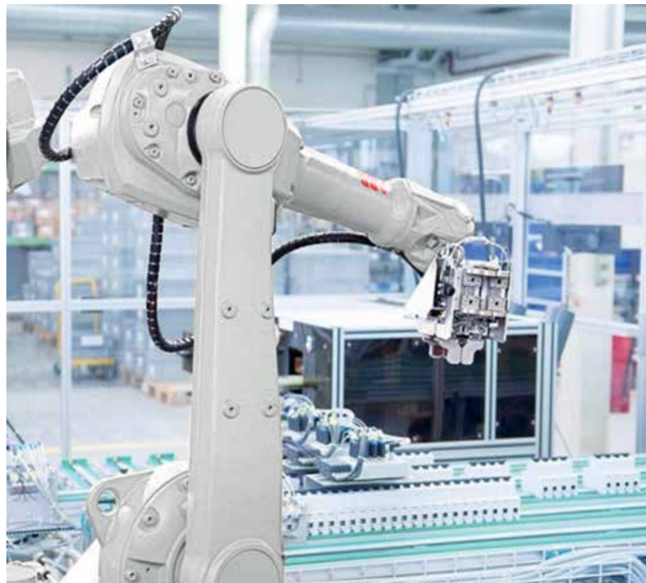
Do pracy na torze jezdny IRBT 2005 nadają się m.in. średniej wielkości roboty IRB 2600.
