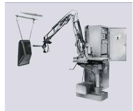
3 Primera versión del robot de pintura Trallfa de 1969
