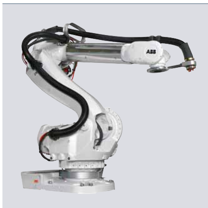
5 El IRB 6000, con su diseño modular, se presentó en 1991 y fue el robot de soldadura por puntos de ABB más vendido.
