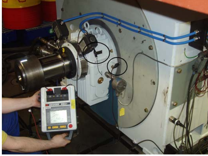
Resim 7-3 Kovansız yatak izolasyon direncini ölçme
