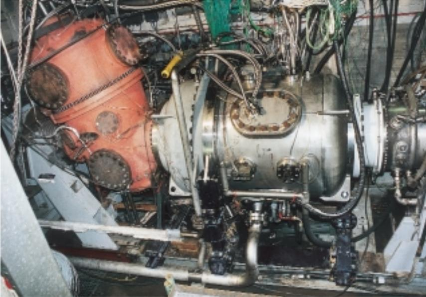
**Instalación de prueba del combustor SEV con alimentador de gases calientes (izquierda) y recipiente a presión SEV (derecha)** **19**
