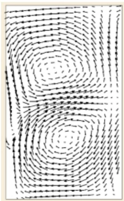
**Configuración calculada de la corriente secundaria en el plano de inyección de combustible (semianchura del canal)** 12
