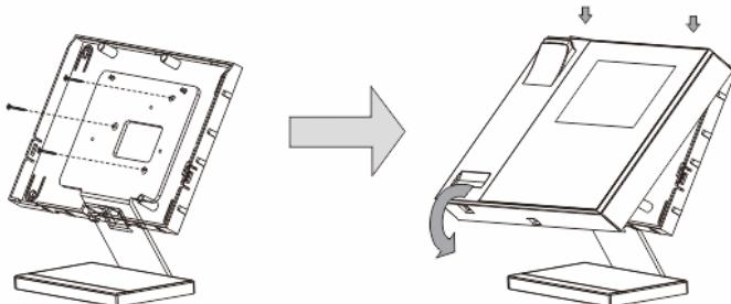
1. Fixer la partie inférieure de l'appareil sur le support de bureau.
