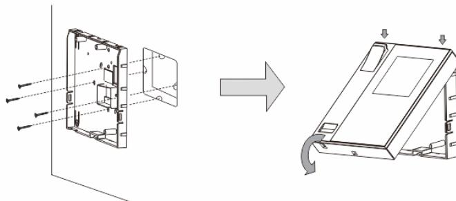
1. Kiinnitä laitteen allaosa olemassa olevaan upotuskoteloon.
