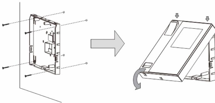
1. Fixe a parte inferior do dispositivo à parede.
