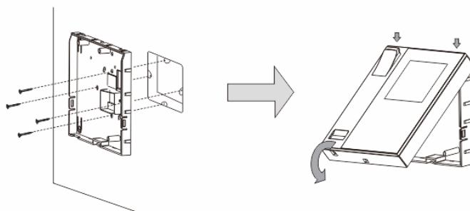
1. Fije la parte inferior del dispositivo a la caja empotable.
