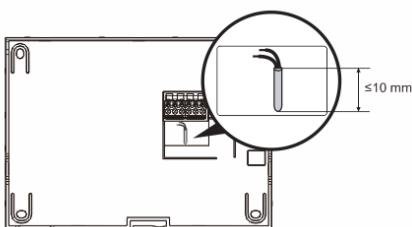
Fissare il fondo del dispositivo e collegarlo come indicato nel grafico. La sezione isolata dell'estremità del cavo non deve superare i 10 mm.
