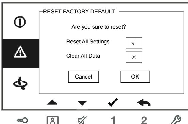
Fig. 23 : Restauration des réglages d'usine par défaut
