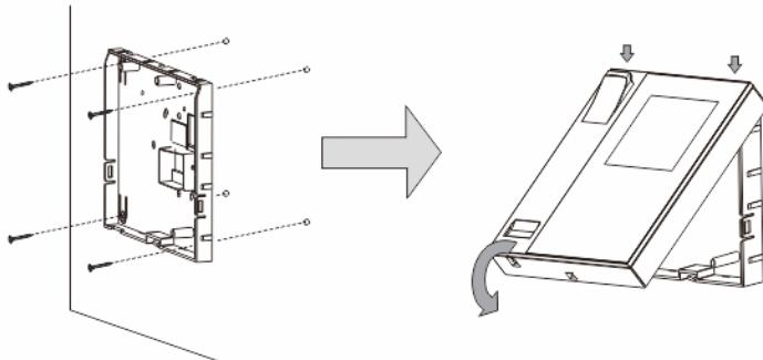
1. Należy przymocować spód urządzenia do ściany.
