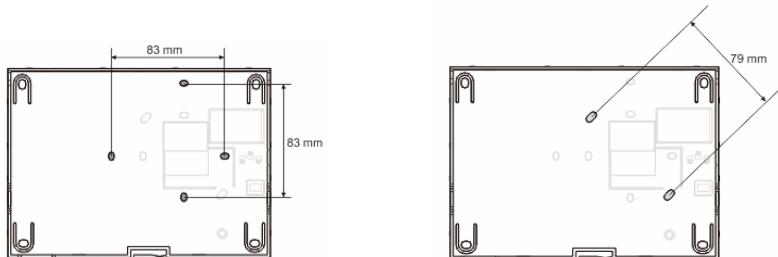
1. В основании устройства имеются отверстия под винты для крепления на стену в соответствии с приведенными выше размерами.
