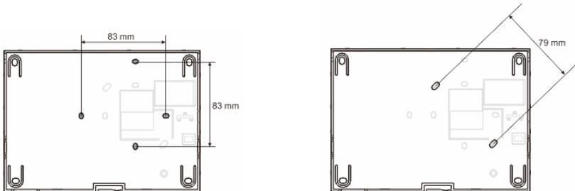
1. La parte inferior del dispositivo tiene orificios para tornillos para su fijación a la pared de acuerdo con las instrucciones de dimensión mostradas anteriormente.
