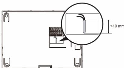
Fixer la partie inférieure de l'appareil et effectuer le câblage en se référant aux figures. La section isolée de l'extrémité de câble ne doit pas mesurer plus de 10 mm.
