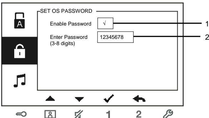
Rys. 14 Ustawienia hasła stacji zewnętrznej
