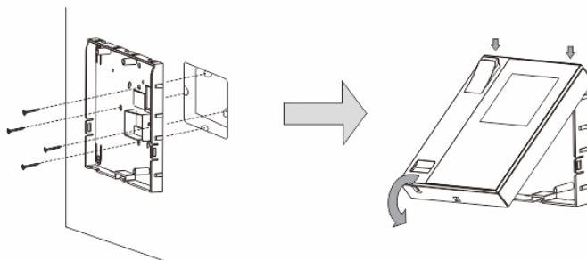
1. Fixe a parte inferior do dispositivo à caixa embutida existente.
