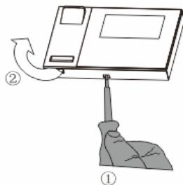
Aprire l'alloggiamento del pannello premendo il gancio sul fondo del dispositivo.
