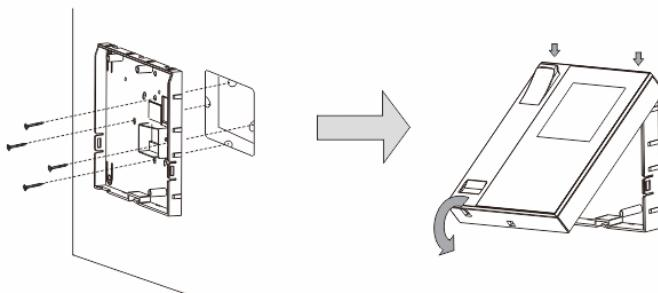
1. Należy przymocować spód urządzenia do istniejącej skrzynki podtynkowej.
