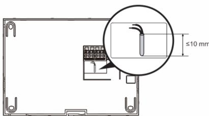
Fixe a parte inferior do dispositivo e ligue-a tendo como referência as imagens. A secção isolada da extremidade do cabo não deve ser superior a 10 mm.
