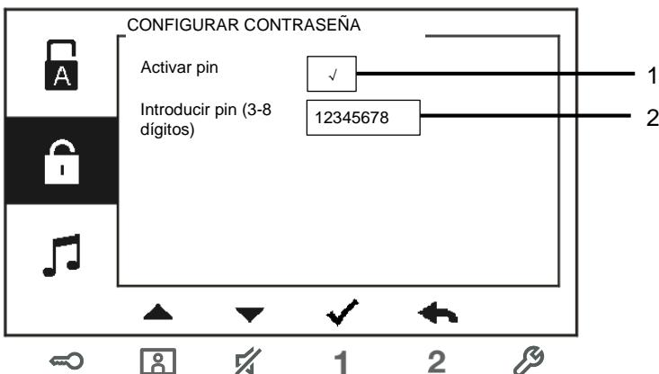
Fig. 14: Configuración de contraseña de la unidad exterior
