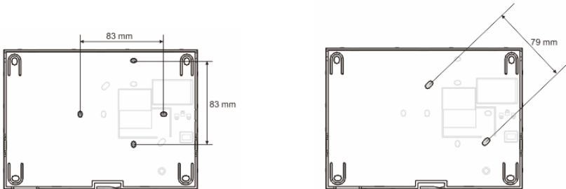
1. Na spodzie obudowy znajdują się otwory na śruby do montażu urządzenia na ścianie zgodnie z powyższymi wymiarami montażowymi.
