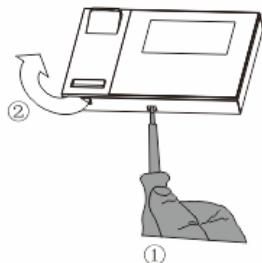
Abra a caixa do painel puxando o grampo na parte inferior do dispositivo.
