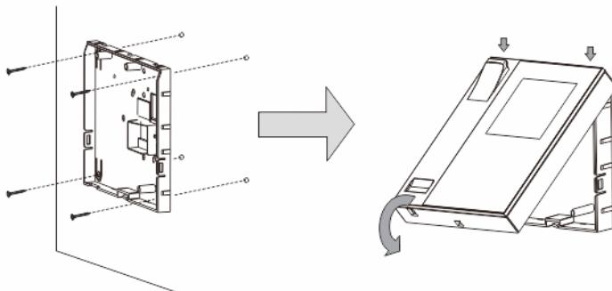
1. Fixer la partie inférieure de l'appareil sur le mur.
