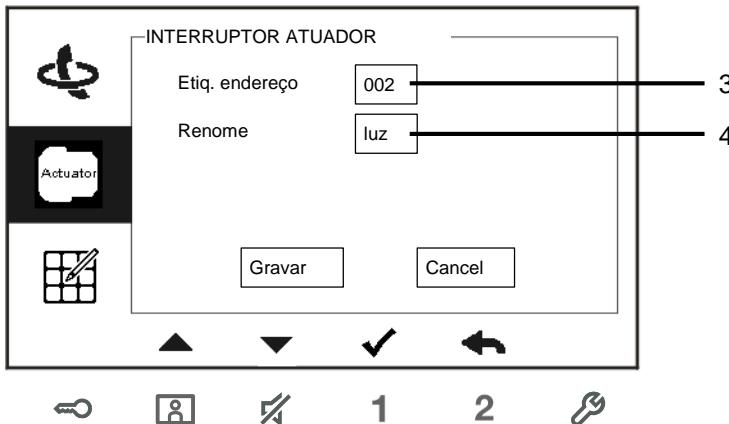
Fig. 10: Configurações do interruptor atuador
