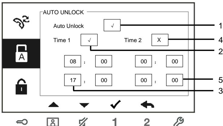
Fig. 13: Indstillinger for automatisk oplåsning
