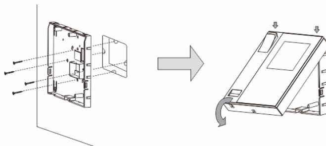
1. Fixer la partie inférieure de l'appareil sur le boîtier encastré existant.
