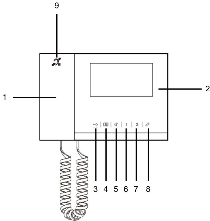
Figur 1 Kontrollelementer
