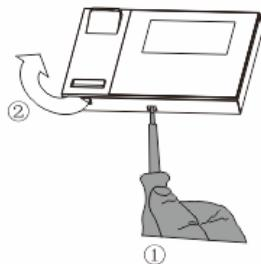
Ouvrir le boîtier en poussant la bride située sur la partie inférieure de l'appareil.
