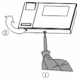
Åpne kabinetet til panelet ved å trekke klemmen på bunnen av enheten.
