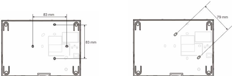
1. Il fondo del dispositivo presenta dei fori filettati per il fissaggio alla parete, delle dimensioni indicate.
