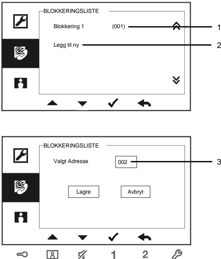
Figur 19: Innstilling for blokkeringsliste
