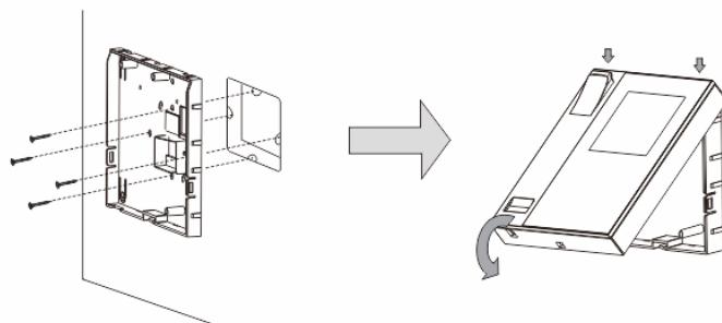
1. Fissare il fondo del dispositivo alla scatola da incasso esistente.
