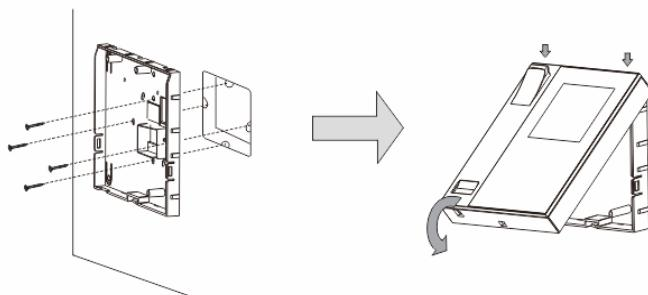
1. Закрепите основание устройства на имеющемся корпусе для установки с утапливанием.
