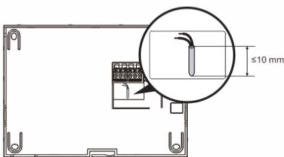
Należy przymocować spód urządzenia i podłącz je zgodnie z instrukcją przedstawioną na rysunkach. Izolowana część końcówki przewodu nie może być dłuższa niż 10 mm.
