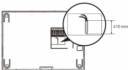
Fest bunnen av enheten, og koble den som vist på bildet. Den isolerende delen av kabelenden må ikke være mer enn 10 mm.
