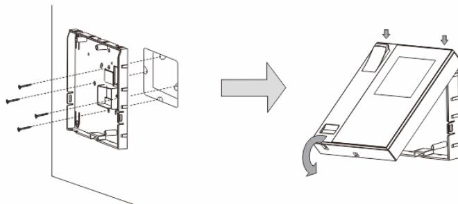
1. Fäst enhetens nederdel på den befintliga försänkta boxen.
