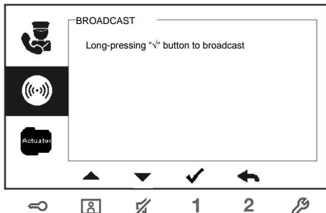
Rys. 6 Nadawanie połączenia
