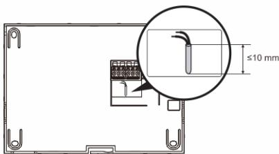
Закрепите основание устройства и подсоедините его согласно схеме. Длина изолированного участка конца кабеля не должна превышать 10 мм.
