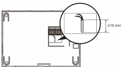
Fije la parte inferior del dispositivo y conéctelo de acuerdo con lo mostrado en los gráficos. La sección aislada del final del cable no debe medir más de 10 mm.
