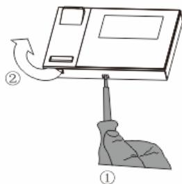
Öppna panelens hölje genom att dra i klämman på enhetens undersida.
