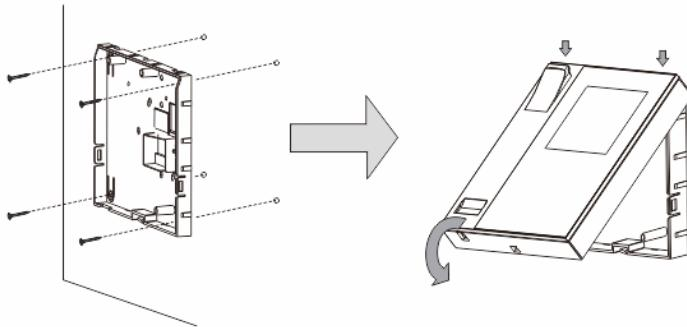
1. Kiinnitä laitteen pohja seinään.
