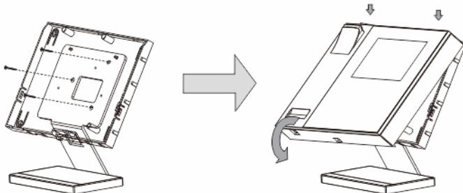
1. Należy zamocować dolną część urządzenia na podstawce na biurko.
