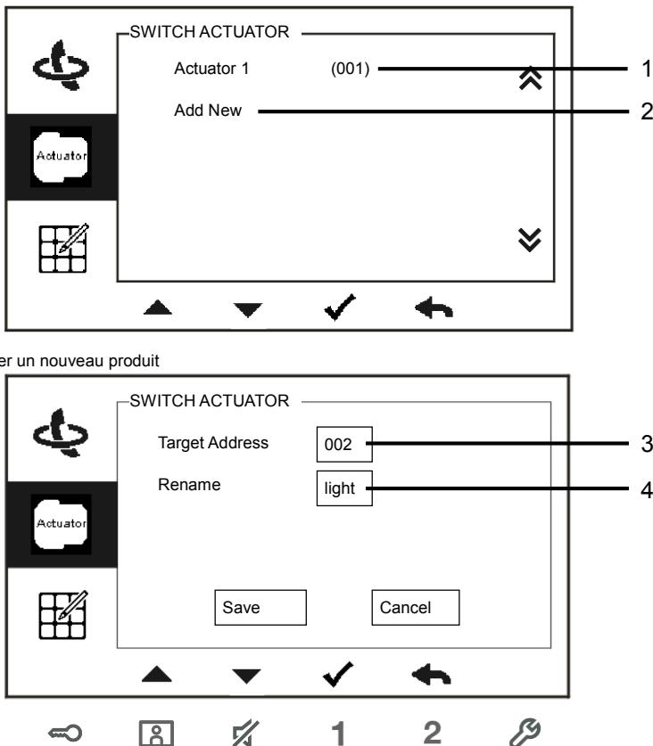
Fig. 10 : Réglages du relais actionneur
