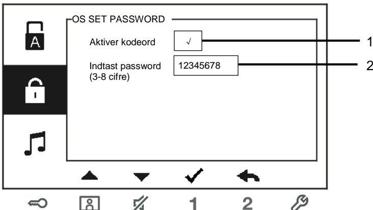
Fig. 14: Indstilling af OS-koden
