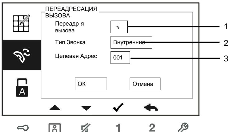
Рис. 12. Настройки переадресации вызовов
