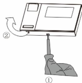
Należy otworzyć panel obudowy, pociągając za zaczep znajdujący się na spodzie urządzenia.
