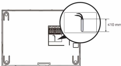
Kiinnitä laitteen pohja ja liitä se kuvituksen mukaisesti. Kaapelin eristetty osa ei saa olla pitempää kuin 10 mm.
