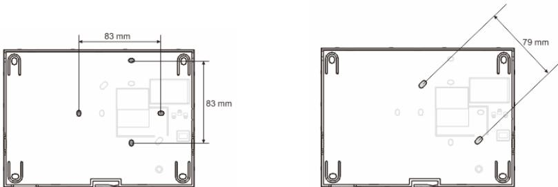
1. A parte inferior do dispositivo possui orifícios para fixação na parede de acordo com as instruções de dimensão acima.
