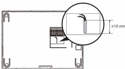
Fäst nederdelen av enheten och anslut den i enlighet med bilderna. Den isolerade delen av kabeländen får inte vara längre än 10 mm.
