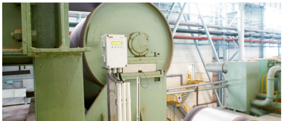
Große PillowBlock-Bandzugmesser in einer Bandbehandlungsanlage für Stahl.
