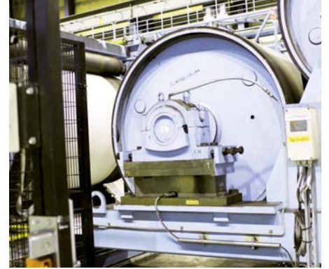
Große PillowBlock-Bandzugmesser in der Spannrolle einer Glüh-/Beizlinie.
