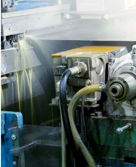
Stressometer-Planheitsregelungssystem in Kombination mit einem Millmate-Bandschanner in einem Reversierwalzwerk.
