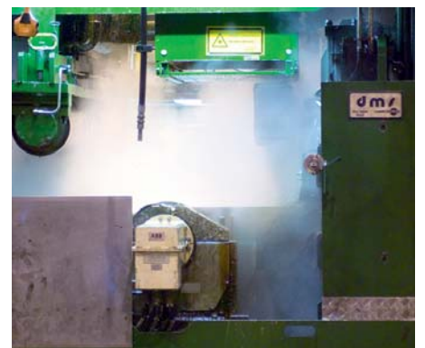
Stressometer-Planheitsregelungssystem in Kombination mit dem Millmate-Bandzugmesser in einem Dressierwalzwerk.
