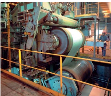
Millmate-Bandzugmessgeber an der Einlauf-Spannrolle eines Tandemkaltwalzwerks.
