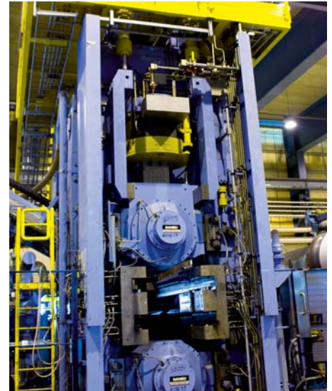
Millmate-Walzkraftmessung in einem Tandemwalzwerk.
