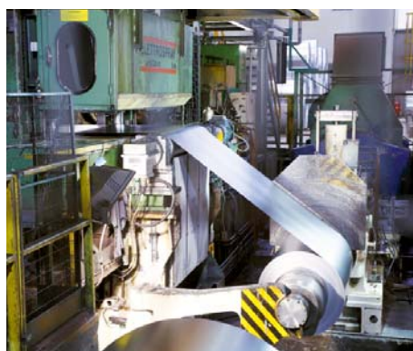
Millmate-Bandschanner und Stressometer-Planheitsregelungssystem in einem Dressierwalzwerk.
