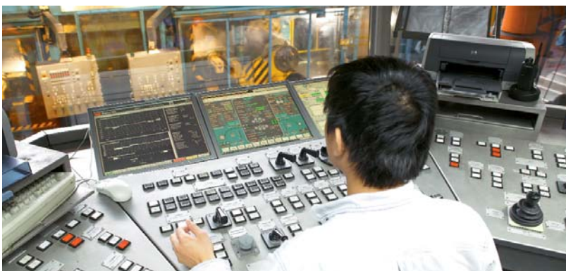
Stressometer-Planheitsregelungssystem in einem Reversierkaltwalzwerk.
