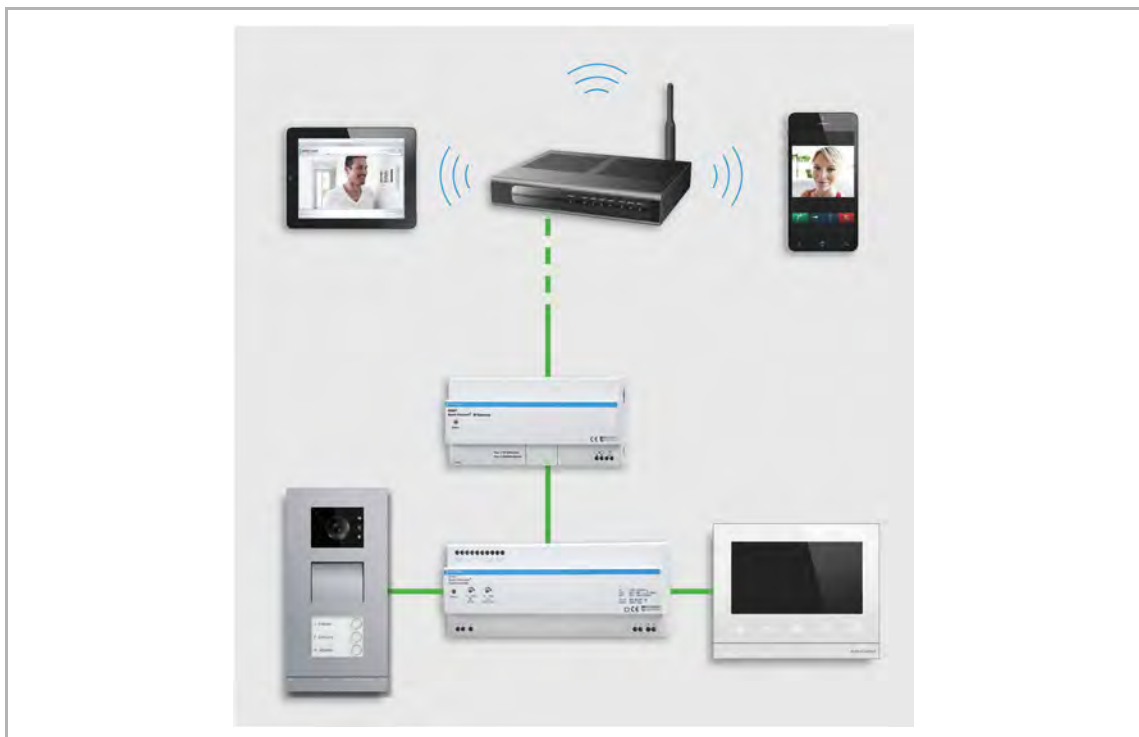
Abb. 72: Türsprechanlage mit IP-Gateway und mobilen Endgeräten
