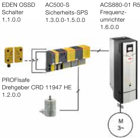
Abbildung 2: Anschlussbeispiel der Funktion Sicher begrenzte Drehzahl (SLS) mit einem ACS880-01 und einer AC500-S Sicherheits-SPS.
