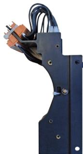
Permitem que a posição do aparelho seja sinalizada a partir de um local remoto. Estão disponíveis 4 contactos auxiliares para a linha e 4 para a terra. Cada contacto pode ser utilizado como um circuito normalmente fechado (NF) ou normalmente aberto (NA). Consulte o esquema do circuito.
