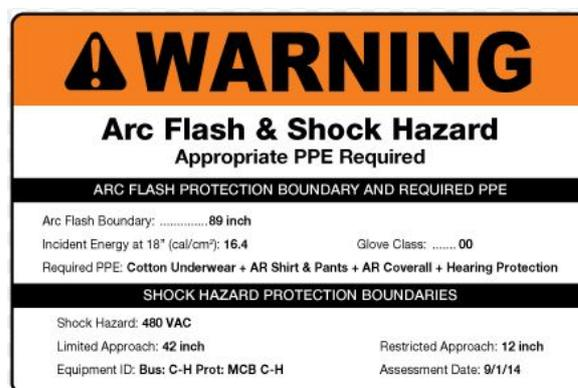
**Fig. 20:** Ejemplo de una etiqueta de descarga de arco eléctrico
