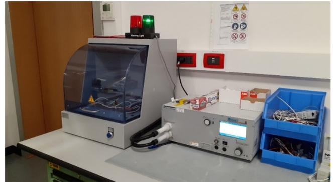
Fig.18 Envoltorio de prueba con sistema de enclavamiento automatizado
