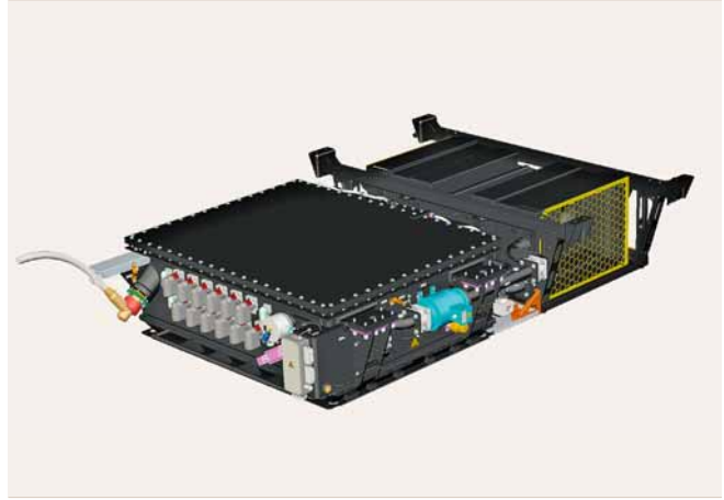
4 ABB-Traktionstransformator für den Velaro D
