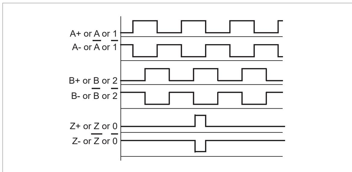
Il canale di uscita dell'encoder che precede quando il convertitore di frequenza esegue una marcia in avanti deve essere collegato all'ingresso A dell'interfaccia FEN-21, mentre il canale di uscita che segue deve essere collegato all'ingresso B dell'interfaccia FEN-21.
