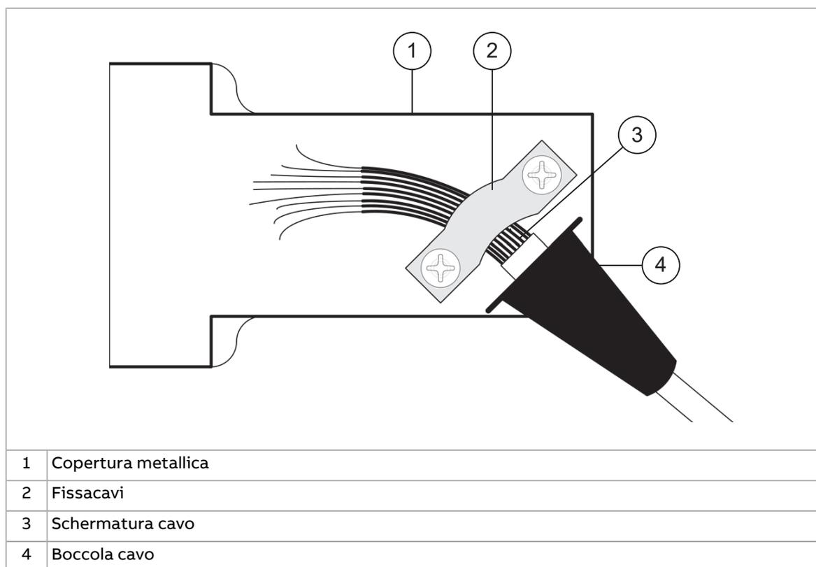
**Nota:** non posare i cavi dell'encoder in parallelo ai cavi di alimentazione (ad esempio del motore).
