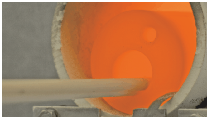
Рисунок 5: Измерение высоких температур до 1800 °C
