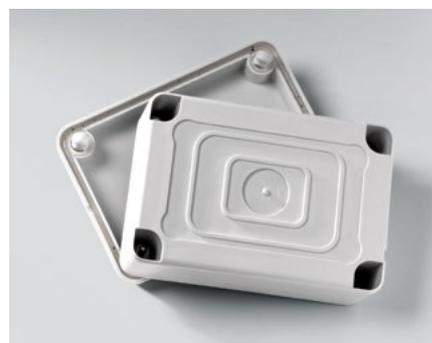
Tutte le scatole di derivazione e stagne IP44, IP55 e IP65 sono disponibili anche in materiale termoplastico, autoestinguento in conformità con la Norma UL 94 V2 e resistenti al calore anormale e al fuoco fino a 960 °C GWT.
