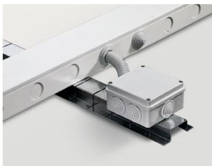
Un'ampia gamma per tutte le esigenze. Esistono versioni IP44 per scatole con coperchio a pressione e passacavi, IP55 per scatole con coperchio avvitato con passacavi e IP65 per coperchio avvitato con lati lisci.
