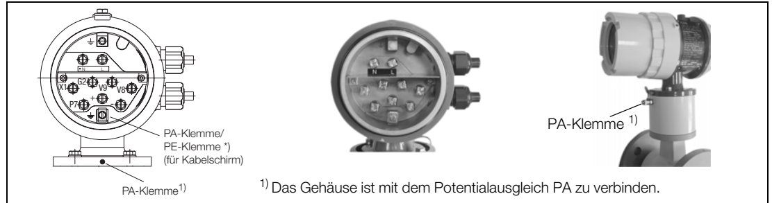
Abb. 35: Anschlussraum FXE4000-DE47F oder FXE4000-DE27, DE27F (COPA-XE)
