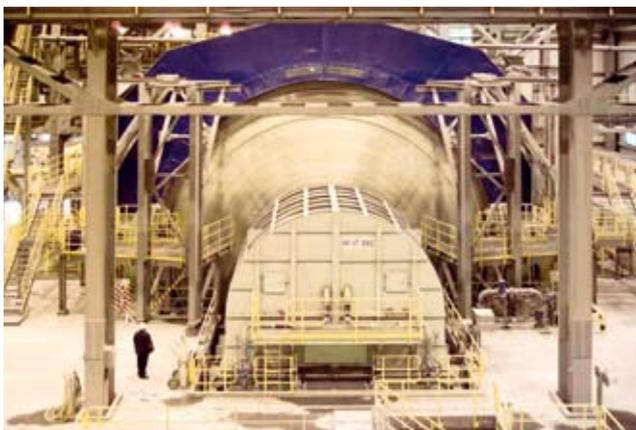
4 Mühle mit getriebelosem Antrieb • Mill with gearless drive
