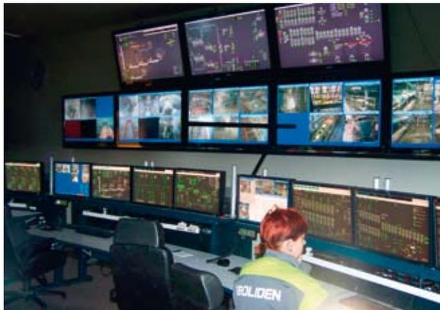
6 ABB-Prozessleitsystem 800xA übernimmt die Steuerung der gesamten Anlage
