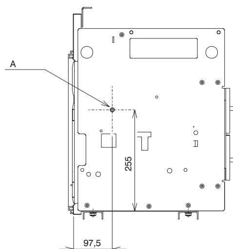
**N.B.:** Ridurre al minimo le curvature del cavo (la loro somma non deve superare il valore di 180°) R minimo di curvatura R=70 mm. Nel fare questo assicurarsi che la forma data al cavo non possa essere modificata dopo la regolazione. Dal punto "A" al punto "B" si hanno a disposizione 650 mm di cavo flessibile.
