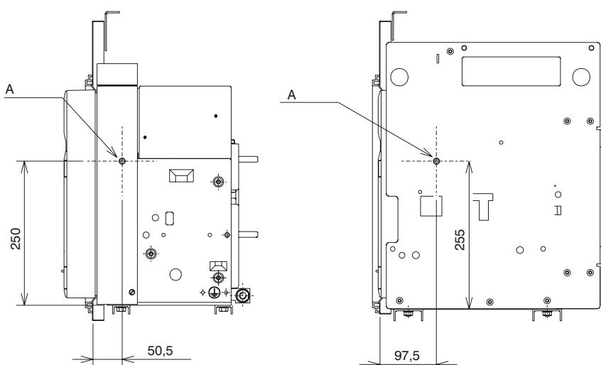
**N.B.:** Ridurre al minimo le curvature del cavo (la loro somma non deve superare il valore di 180°) R minimo di curvatura R=70 mm. Nel fare questo assicurarsi che la forma data al cavo non possa essere modificata dopo la regolazione. Dal punto "A" al punto "B" si hanno a disposizione 650 mm di cavo flessibile.
