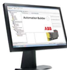
Der ABB Automation Builder deckt das Engineering der SPS, der Sicherheits-SPS, der Bedienpanels, der Antriebe sowie Motion und Roboter ab.
