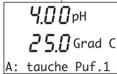
**Kalibrieren des Puffers (Einpunktkalibrierung) oder Kalibrieren der Pufferlösung 1 (Zweipunktkalibrierung)**
