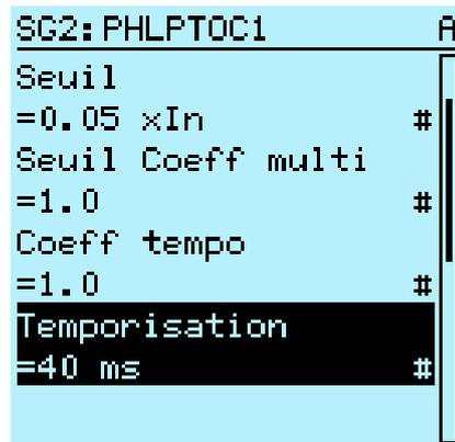
Figure 90: Paramètre de groupe de réglages
