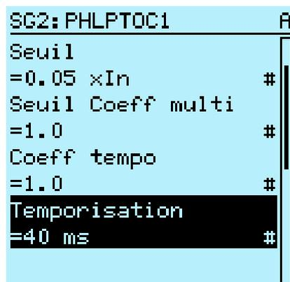
Figure 80: Paramètre de groupe de réglages
