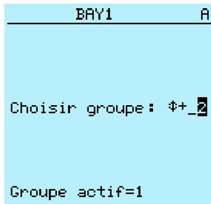
Figure 88: Sélection d'un groupe de réglages
