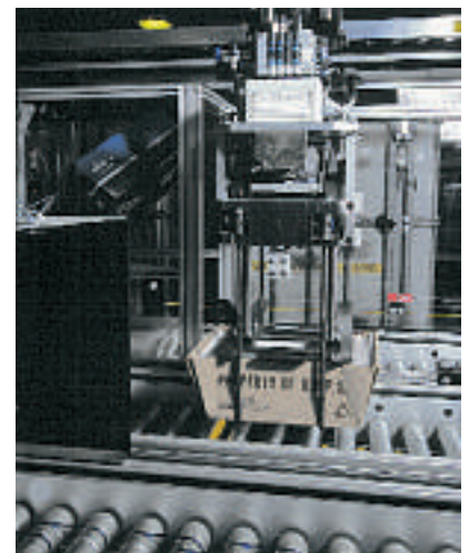
Robot portique saisissant un plateau à moitié rempli sur un convoyeur de recirculation
