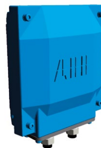
Boîte à bornes auxiliaire en fonte (code option 567). 208 x 180 mm, pour 30 fils maxi. Mise à la terre M6
