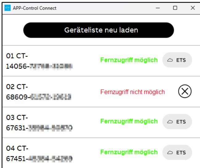
Das graue Symbol zeigt an, dass eine KNX-Remote-Verbindung gestartet werden kann, und das blau blinkende Symbol zeigt an, dass die KNX-Remote-Verbindung gerade aufgebaut wird.
