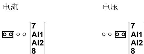
J2 – 用来选择模拟输入 AI2 的输入信号是电流信号还是电压信号。
