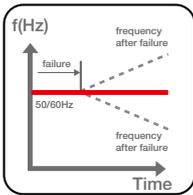
**Velocidad de variación de la frecuencia (ROCOF – ANSI 81R):** permite la rápida identificación de las variaciones de frecuencia tanto positivas como negativas. Esta protección es constante e interviene cuando la variación de frecuencia en Hz/s supera el umbral programado.
