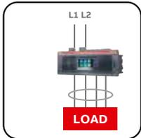
**Corriente residual (Rc – ANSI 64 & 50NDT):** a temperatura constante ( $t=k$ ), protege contra los contactos indirectos y está integrada en Ekip UP Protect y Ekip UP Protect+ por un rating plug de corriente residual dedicado y toroidal externo. La protección es una alternativa respecto a las funciones G y Gext y se activa con rating plug dedicados.
