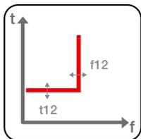
**Mínima frecuencia (UF - ANSI 81L):** con tiempo de actuación constante ( $t = k$ ), la función interviene cuando la frecuencia de red desciende por debajo del umbral programado.
