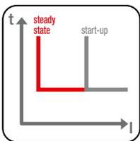
**Función de arranque:** : permite a las protecciones S, I y G operar con umbrales de actuación más elevados durante la fase de arranque; de esta forma, se evitan ciertos disparos intempestivos debidos a las corrientes de arranque elevadas de ciertas cargas (motores, transformadores, luminarias). La fase de arranque dura de 100 ms a 30 s y el relé la reconoce automáticamente:
