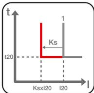
**Protección contra sobreintensidad con control de tensión (S(V) - ANSI 51V):** protección contra sobreintensidad con tiempo de actuación constante ( $t = k$ ), sensible al valor de la tensión. Después de una disminución de la tensión el umbral de corriente programado disminuye gradualmente o en modo lineal.
