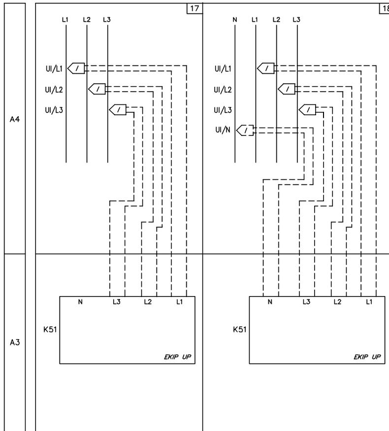
**19A) Puentes para unidad Ekip UP sin conexiones de corriente**
