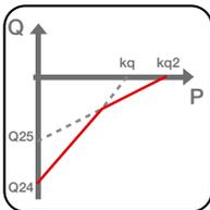
**Segunda protección contra la pérdida de excitación o inversión de potencia reactiva (RQ – ANSI 40 o 32RQ):** permite seguir con la máxima precisión la curva de subexcitación del generador, evitando de este modo deslastes innecesarios.
