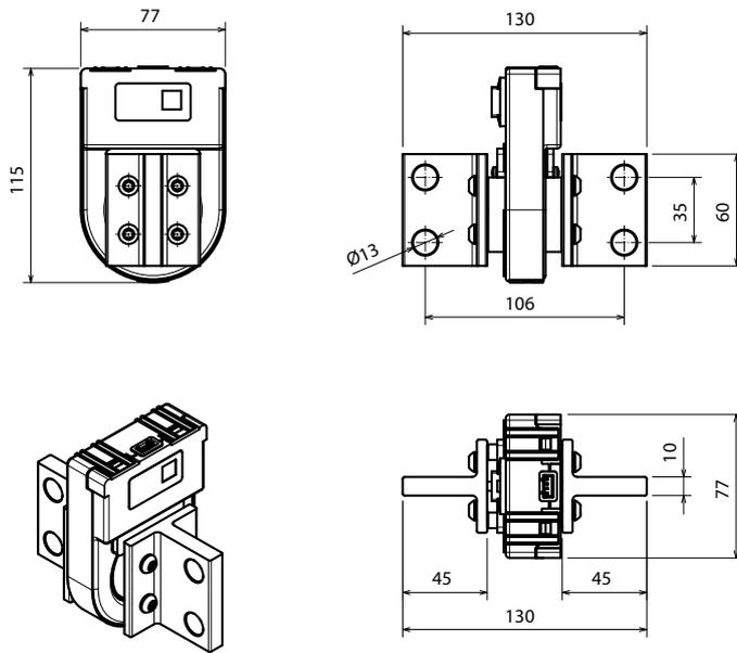
**Sensor de corriente tipo A 2000A-4000A**
