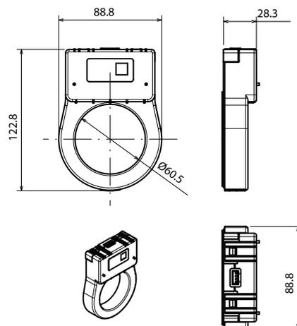
**Sensor de corriente tipo B hasta 1600 A**
