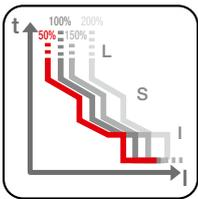
**Protección del neutro:** disponible al 50%, 100%, 150% o 200% de las corrientes de fase, o deshabilitada si está aplicada a las protecciones de sobrecarga L, S y I.
