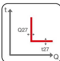
**Máxima potencia reactiva (OQ – ANSI 32OF):** con tiempo de actuación constante ( $t = k$ ), la función interviene cuando la potencia reactiva supera el umbral programado en el generador en dirección de la red.
