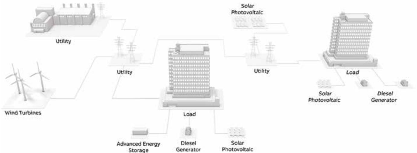
Para maximizar la continuidad del servicio, el sistema de generación local pone en función la alimentación de la instalación del usuario en modo isla. La unidad Ekip UP integra un estado programable basado en medidas, eventos y protecciones, permite por lo tanto la creación de lógicas de conmutación. Además, puede ser integrada fácilmente con controlador ATS (conmutación automática) en proyectos de renovación.
