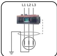
**Defecto a tierra diferencial (Rc - ANSI 87N):** protege contra el defecto a tierra interno en el devanado del generador. Es necesario que el toroidal envuelva los conductores activos y el conductor de tierra. La protección Rc está integrada con un rating plug de corriente residual dedicado y con el toroidal externo.
