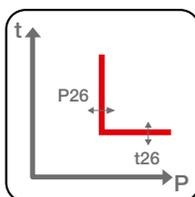
**Máxima potencia activa (OP – ANSI 32OF):** con tiempo de actuación constante ( $t = k$ ), la función interviene cuando la potencia activa supera el umbral programado en la dirección de suministro del generador.
