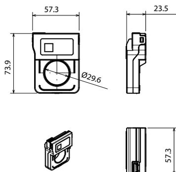
**Sensor de corriente tipo B 400A-1600A**
