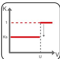
En la modalidad gradual o controlada la protección interviene en el umbral programado ( $I_{20}$ ) si la tensión es superior a U, mientras que interviene en el umbral inferior del factor  $K_s$  ( $I_{20} * K_s$ ) si la tensión es inferior a U.
