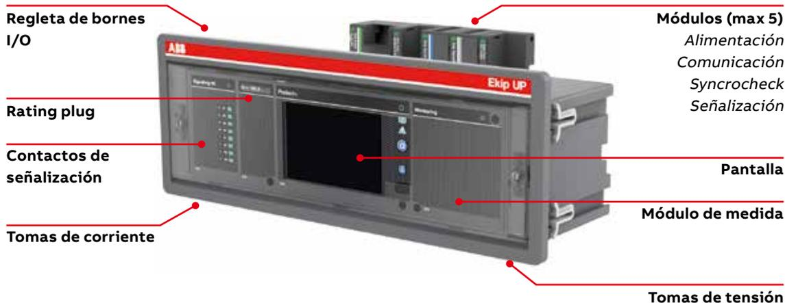
La unidad Ekip UP puede montarse en un carril DIN o en la puerta, según las exigencias específicas. La unidad está fijada con numerosas bridas que garantizan estabilidad en todas las instalaciones. La posibilidad de girar las bornas de conexión de los contactos y dos etiquetas que facilitan su uso en ambos tipos de montaje.
