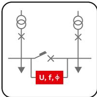
**Synchrocheck (SC - ANSI 25):** la función de control del sincronismo compara las tensiones en los módulos, como así también las frecuencias y las fases de dos aparatos de maniobra a los que está conectado el interruptor. Ekip UP señala cuando se alcanzan las condiciones también con indicadores de sincronismo en la pantalla, que permiten poner en paralelo las dos líneas.
