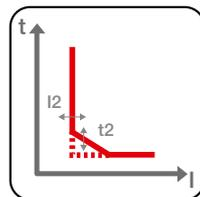
**Máxima corriente con actuación retardada (S - ANSI 51 & 50TD):** con tiempo de actuación constante ( $t = k$ ), o con energía específica pasante constante ( $t = k/I_2$ ), dispone de 15 umbrales de corriente y 8 curvas, para un ajuste fino.
