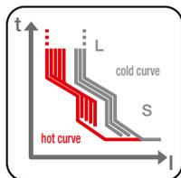
**Memoria térmica:** para protecciones L y S. Se usa para proteger los componentes (por ejemplo los transformadores) del recalentamiento debido a sobrecarga. La protección adapta el tiempo de actuación de la protección en base al tiempo transcurrido desde la primera sobrecarga, teniendo en cuenta el recalentamiento causado.
