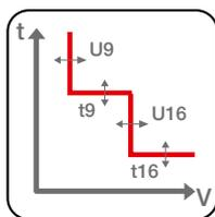
**Segunda protección de mínima y máxima tensión (UV2 y OV2 – ANSI 27 y 59):** permite definir dos umbrales de mínima y máxima tensión con retardos distintos, en modo tal de poder discriminar, por ejemplo, entre disminuciones transitorias de la tensión debidas al arranque de un motor y un fallo verdadero.
