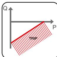
**Pérdida de excitación o inversión de potencia reactiva (RQ – ANSI 40 o 32RQ):** con tiempo de actuación constante ( $t = k$ ), el interruptor interviene cuando la potencia reactiva total absorbida por el generador supera el umbral programado. Es posible seleccionar el umbral constante ( $k=0$ ) o una función de la potencia activa suministrada por el generador ( $k \neq 0$ ).
