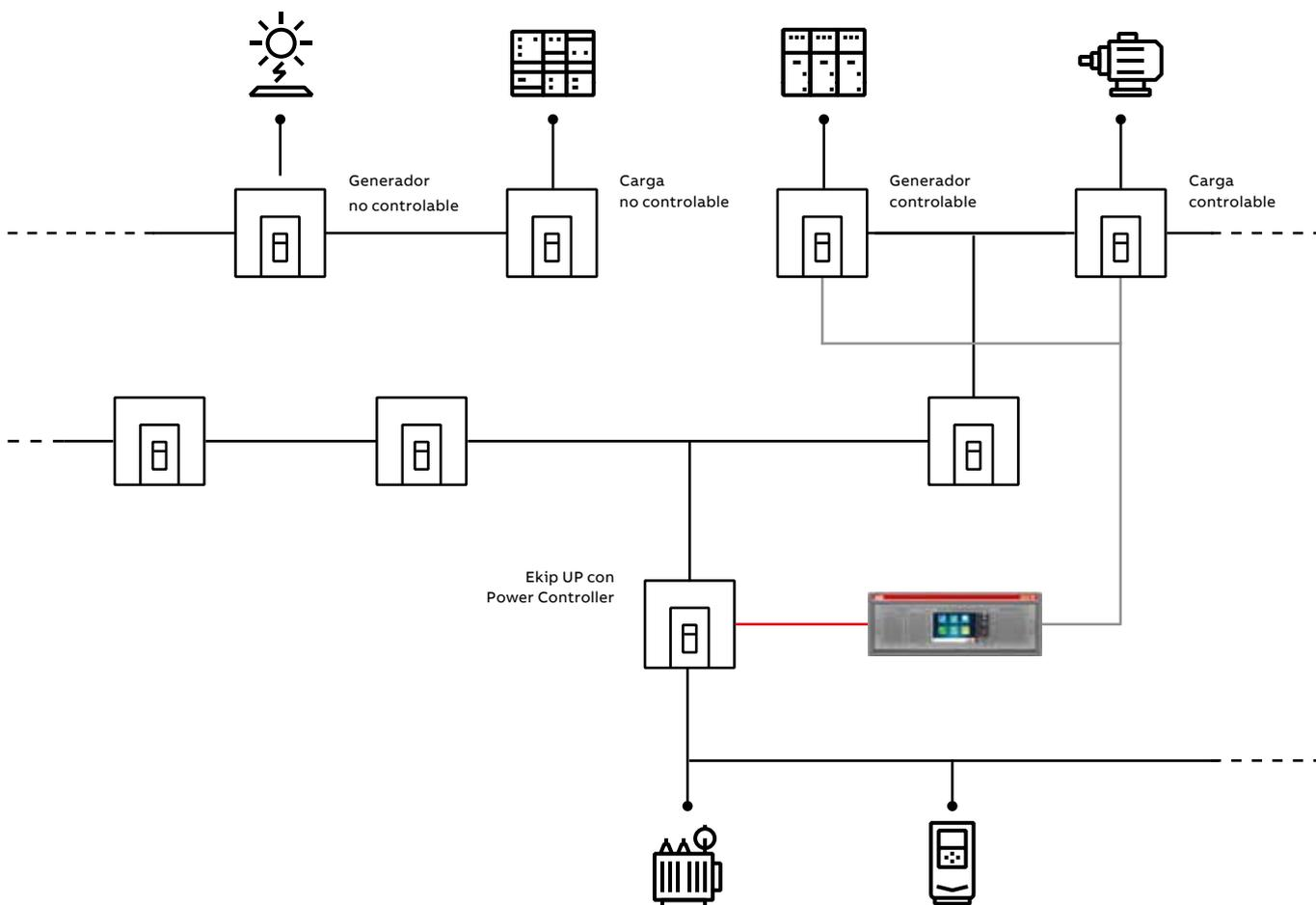
En las instalaciones ya provistas de sistemas de gestión de la energía, el límite de carga puede ser modificado a distancia. Otra posibilidad de recibir setpoint de potencia de los agregadores de carga o de las redes de distribución está dada por el estándar de comunicación openADR (véase el cap. 4).
