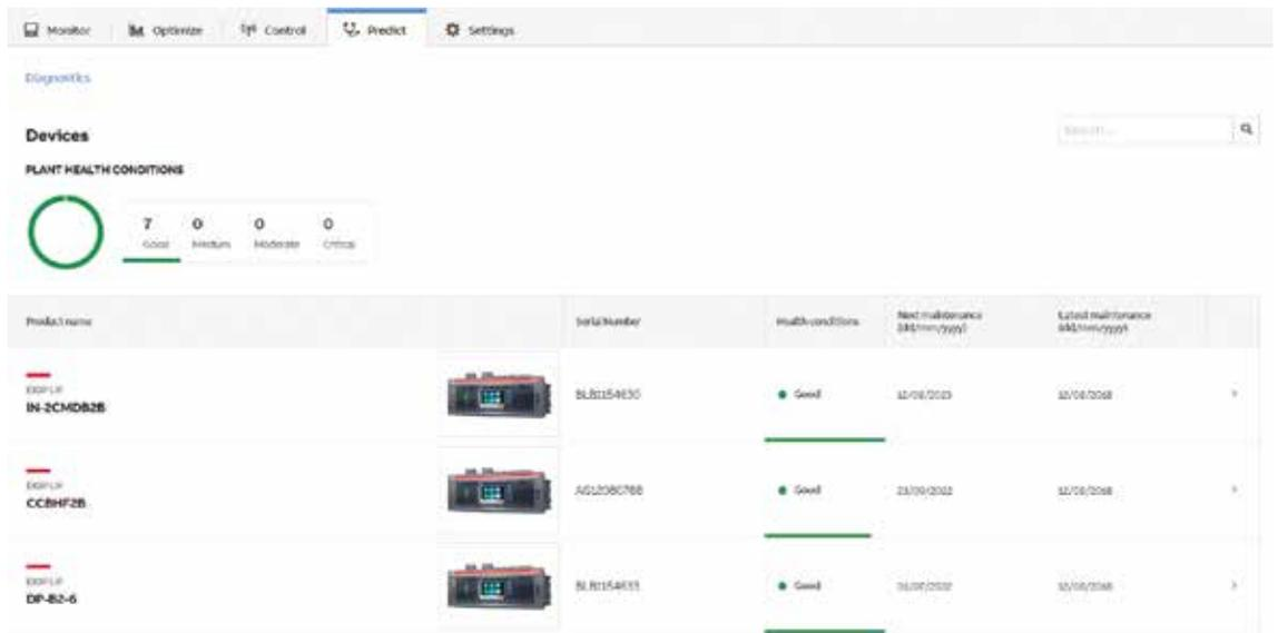
La unidad muestra además la fecha del último mantenimiento efectuado en el aparato. Seleccionando un determinado aparato, la curva de fiabilidad mostrará el comportamiento histórico hasta ese momento.
