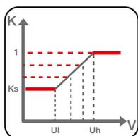
Se seleccionan dos límites de tensión en modalidad lineal (modalidad restringida) dentro de los cuales la protección interviene al umbral programado ( $I_{20}$ ) reducido del factor  $K$  correspondiente a la tensión medida. La variación del factor  $K$  es proporcional a la tensión; para tensiones mayores que el umbral superior ( $U_h$ ) se aplica el umbral  $I_{20}$ , mientras que para las tensiones por debajo del umbral inferior ( $U_l$ ) se aplica el umbral mínimo ( $I_{20} * K_s$ ).
