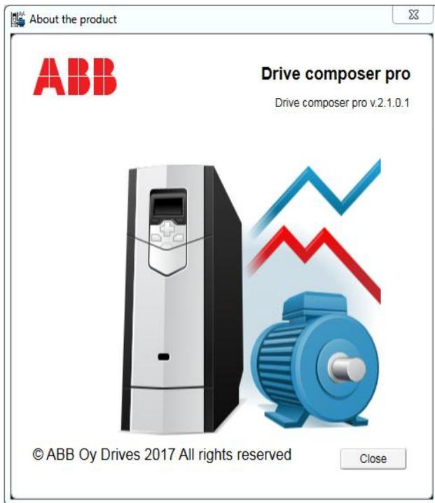
作为全新的调试工具软件，Drive Composer也比Drive Window具有更加强大的功能。首先，一改原Drive Window软件的连接接口是光纤这一较为特殊专用的介质，Drive Composer使用标准的USB电缆或标准的以太网线将传动和电脑连通，这也在一定程度上降低了用户的使用成本。下面我们就为大家介绍几点Drive Composer的新功能和使用技巧。
