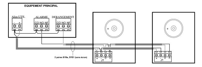
Le schéma ci-dessus indique le principe de fonctionnement. Pour le raccordement, se reporter à la notice de l'équipement principal. (Ex. BAAS PR, ATS, AI 1B T4 & AI 2B T4)
