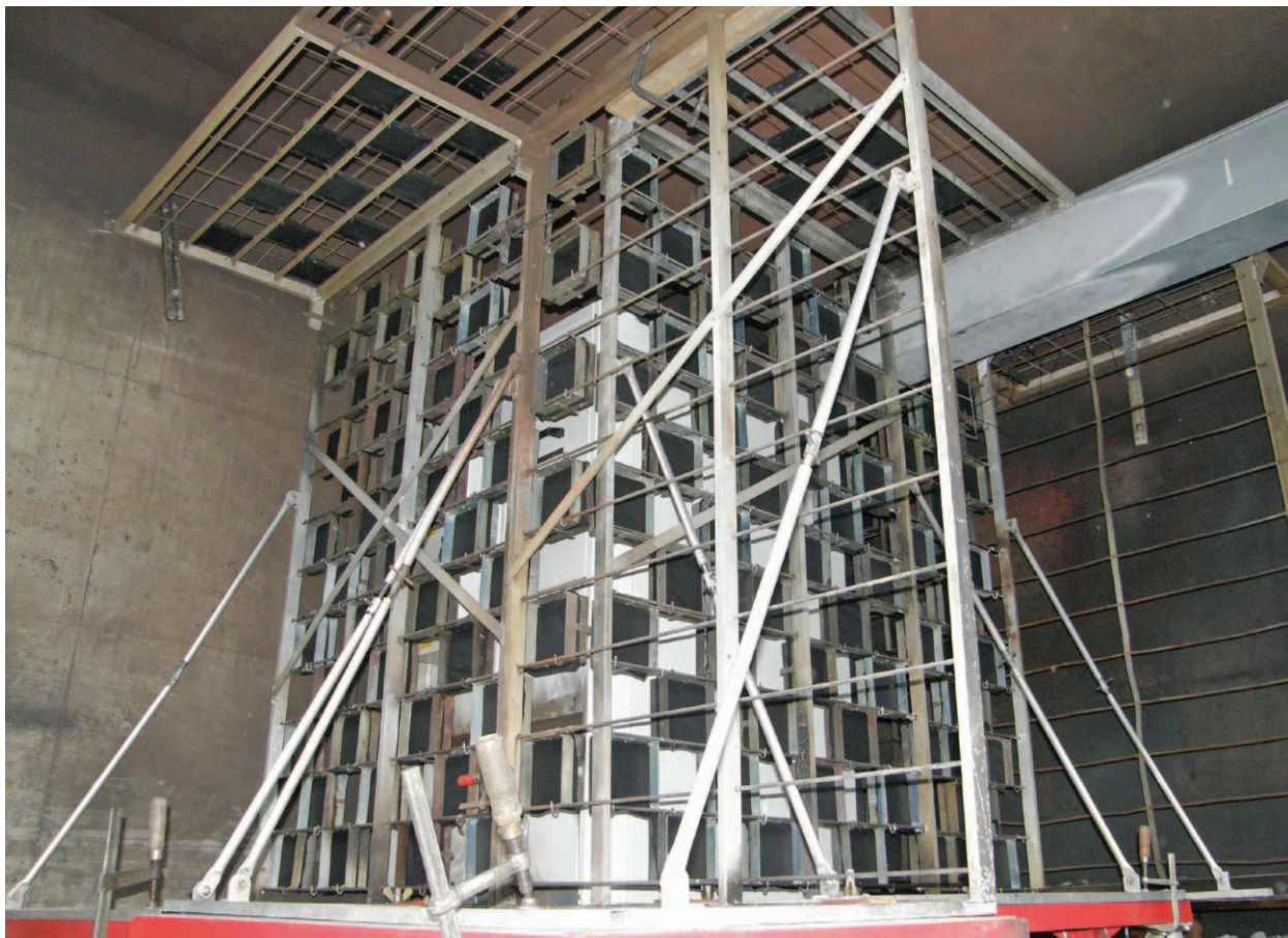
— Configuration pour un essai de résistance aux arcs internes
