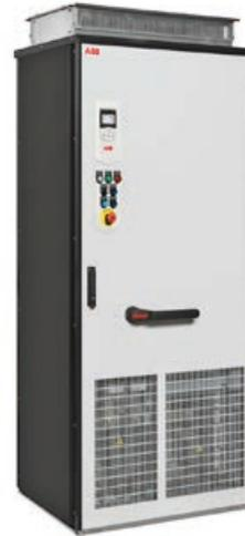
Nuestros convertidores únicos de instalación en armario se fabrican a medida para responder a sus necesidades, independientemente de cuáles sean las dificultades técnicas. La configuración del convertidor comprende un rectificador, un enlace de CC, un inversor, fusibles, reactancia de línea y un interruptor principal, todo ello integrado en un armario compacto para facilitar su montaje y puesta en marcha.
