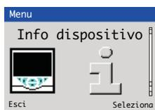
Utilizzato per visualizzare i parametri impostati di fabbrica di sola lettura del regolatore.
