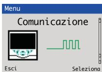
Utilizzato per impostare i parametri di comunicazione dei protocolli di comunicazione MODBUS / Ethernet (opzionale) – vedere la Guida utente separata (IM/CM/C-EN).
