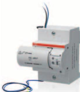
Progettati per l'installazione nei centralini domestici, i dispositivi F2C-ARH consentono la richiusura automatica dei differenziali puri bipolari ABB F200 fino a 63 A, con sensibilità pari a 30 e 100 mA. In caso di scatto del differenziale associato, essi effettuano la chiusura dell'interruttore dopo aver verificato l'assenza di guasti, mediante una prova d'isolamento.
