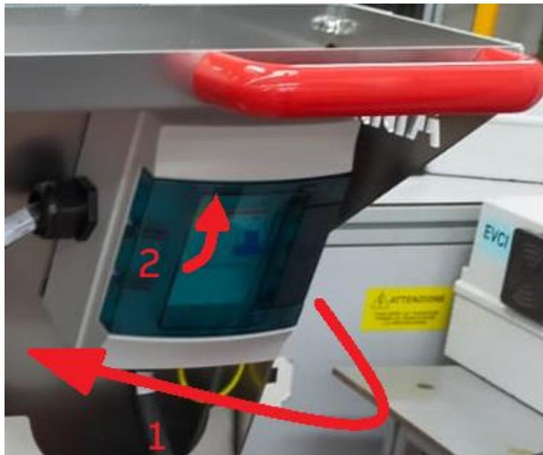
7. Retirer le connecteur CCS2 du support pistolet et le connecter au véhicule.
