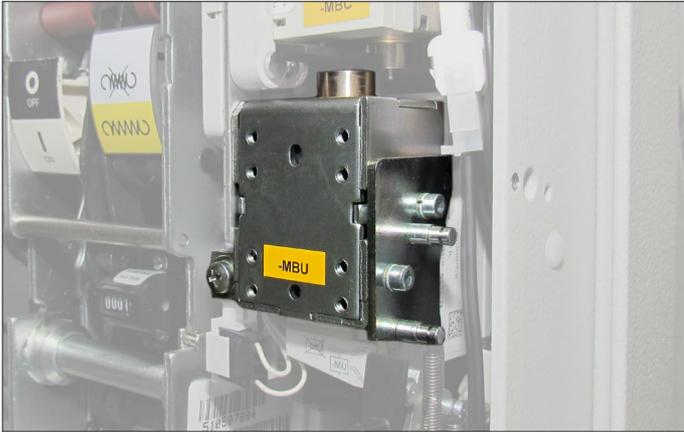
O relé de mínima tensão realiza a abertura do disjuntor em caso de redução significativa ou ausência de alimentação para o mesmo. Permite o fechamento do disjuntor somente com o relé alimentado (o bloqueio do fechamento é realizado mecanicamente).
