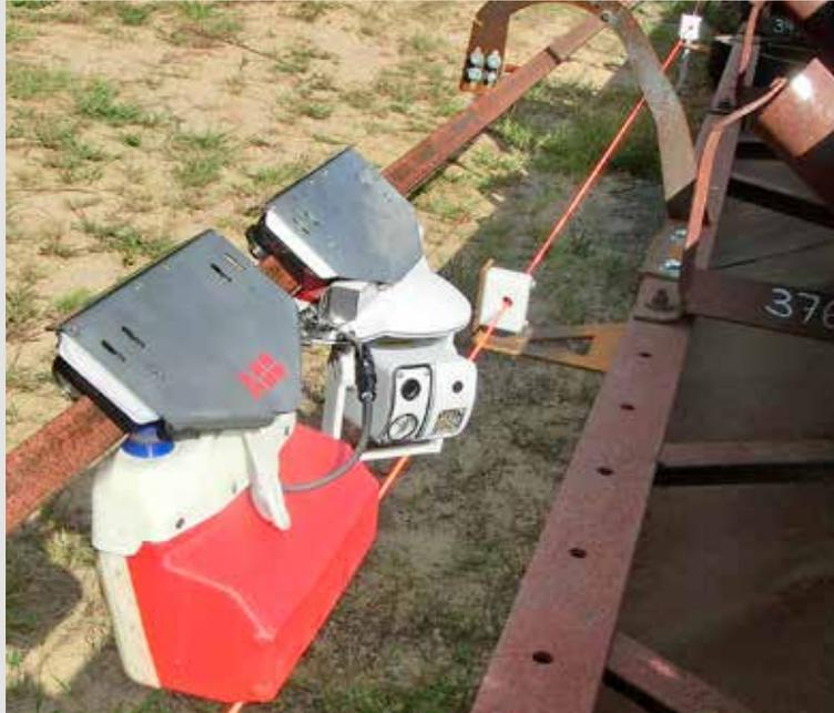
La fiabilité est un paramètre clé des systèmes de convoyage minier. Les solutions de suivi d'état surveillent généralement bien les moteurs, entraînements, courroies et transformateurs des convoyeurs, mais pas les milliers de rouleaux porteurs de la bande et de la charge. Or un rouleau défaillant consomme de l'énergie en pure perte, use la bande ou entraîne son décentrage, quand ce n'est pas sa rupture ou un incendie.
