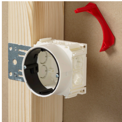
Vid användning av två gipsskivor, ta bort den röda ringen och justera monteringsfästet ett steg.
