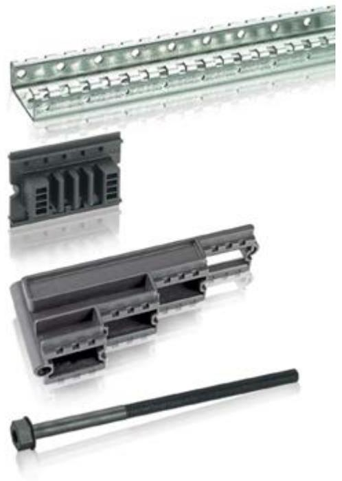
Le support de barres linéaire est composé de supports isolants enclipsé côte à côte sur les traverses qui sont fixées directement à l'intérieur du tableau avec de simples équerres.
