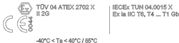
Abbildung 1: Ex-Kennzeichnung (Beispiel, ATEX / IECEx)
