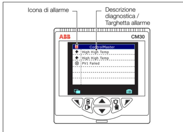
Fig. 5.2 Visualizzazione diagnostica ControlMaster
