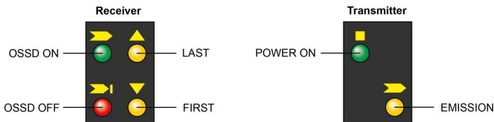
Abbildung 34 – LEDs an Empfänger und Sender
