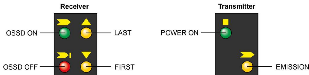
Abbildung 22 – Displays auf Sender und Empfänger
