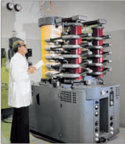
Première valve à vapeur de mercure pour le transport d'énergie en CCHT
