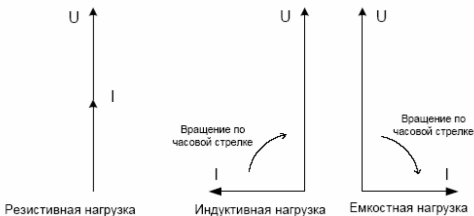
Рис. 5-1. Векторная диаграмма резистивной, индуктивной и емкостной нагрузки
