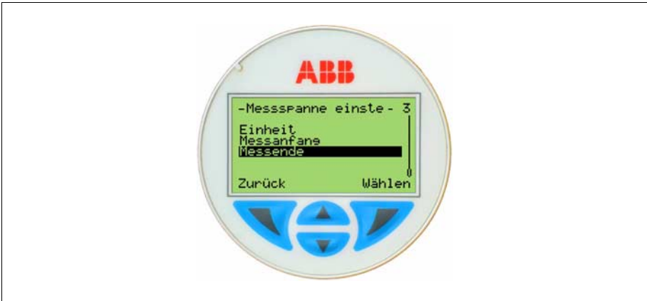
Bild 5-9: Einstellung mit integriertem LCD-Anzeiger und Konfiguriertasten
