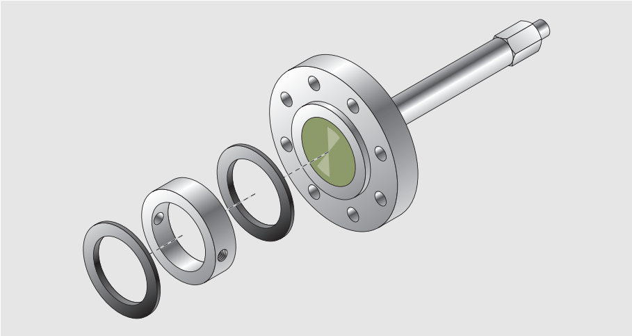
Bild 13-7: Druckfühler mit Spülring
