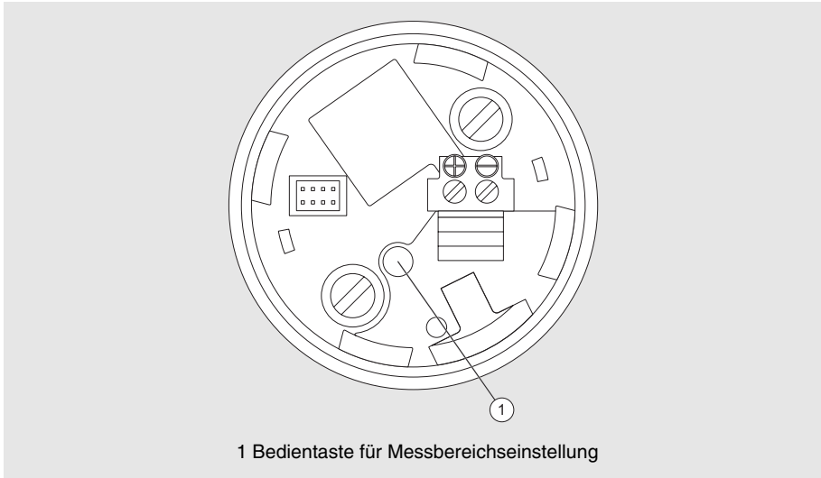
Bild 5-8: Einstellung von Messbereichsanfang und Messbereichsende mit Bedientasten
