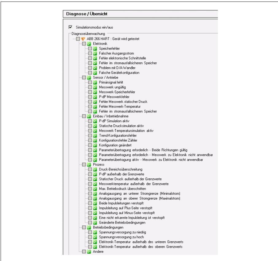
Bild 5-16: Simulation der Diagnosemeldungen mit DTM
