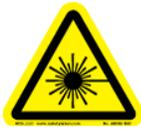
Ein Klasse 1M Laser (905nm) ist für alle Verwendungsbedingungen sicher, solange keine optischen Instrumente, wie Lupen oder Ferngläser verwendet werden.
